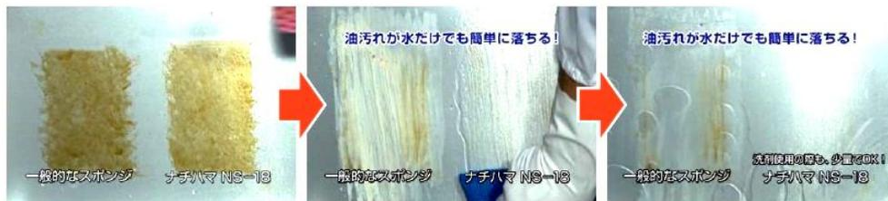
■異物混入対策用スポンジの摩耗比較試験
