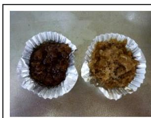
左のECO2の比較写真は、左側が、⑧のG-510 50倍希釈(手洗い食器用)と右側が、④の業務用手洗用食器洗剤です。油の吸着効果の違いが判ります。洗剤が変わると吸着材の効果も向上し、油脂の流出量を大幅に抑える事ができる。
